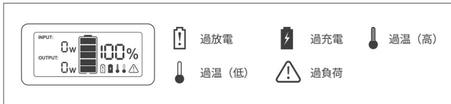
**INPUT:**本機に蓄電を行う際に接続されたソーラーパネル、ACアダプター、シガーソケットから供給されている電力が表示されます。
